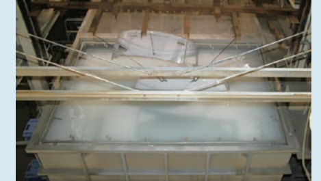
▲純水洗の加温に乾燥炉の廃熱を再利用
