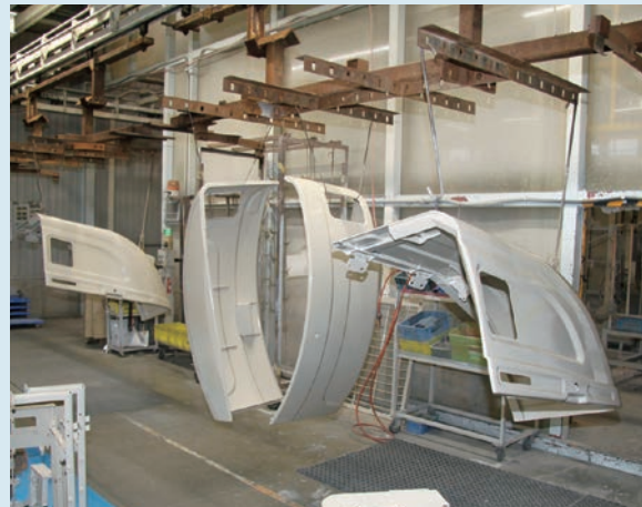
▲ 電着塗装完了 粉体塗装ラインへと進行する
