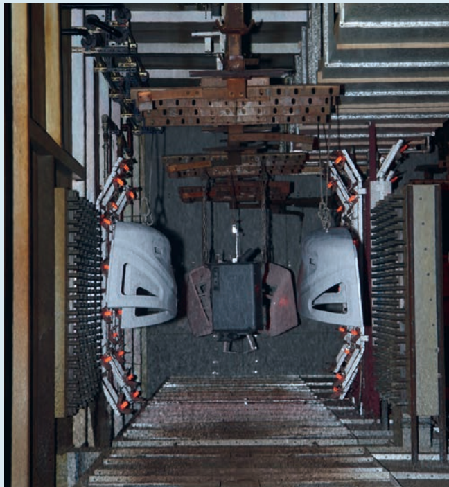
▶ ハイブリッド炉内の様子 手前がバーナーブロー、奥が中長波カーボンヒーター
