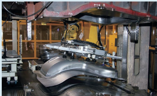
▲プレス後は移載ロボットにてプレス品を移動
